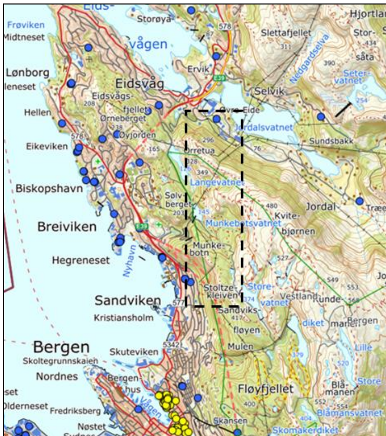
Figur 5-4: Grunnvannsbrønner markert med blå punkter, området for planlagt tunnel er vist med stiplede linje
